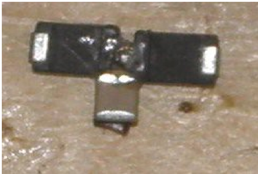
Abb. 2.5-3: Dioden mit Cx (Vielschichtkondensator 22 \mu F/25V)
